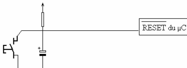
Fig.III.4 : Circuit de reset
